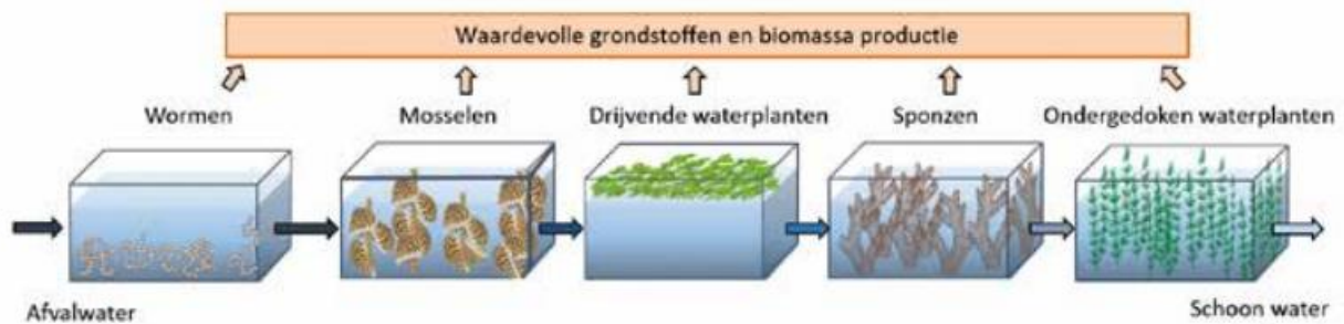
Figuur 3-6 Zuiveringsproces Aquafarm (bron: Aquafarm)
